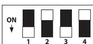
Für die Steuerung der Pumpen von 9 bis 12
