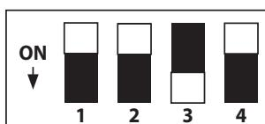
Für die Steuerung der Pumpen von 5 bis 8
